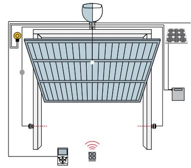
1. Spinbus 2. Trasmittitore 3. Fotocellule 4. Luce lampeggiante 5. Selettore a chiave o digitale
