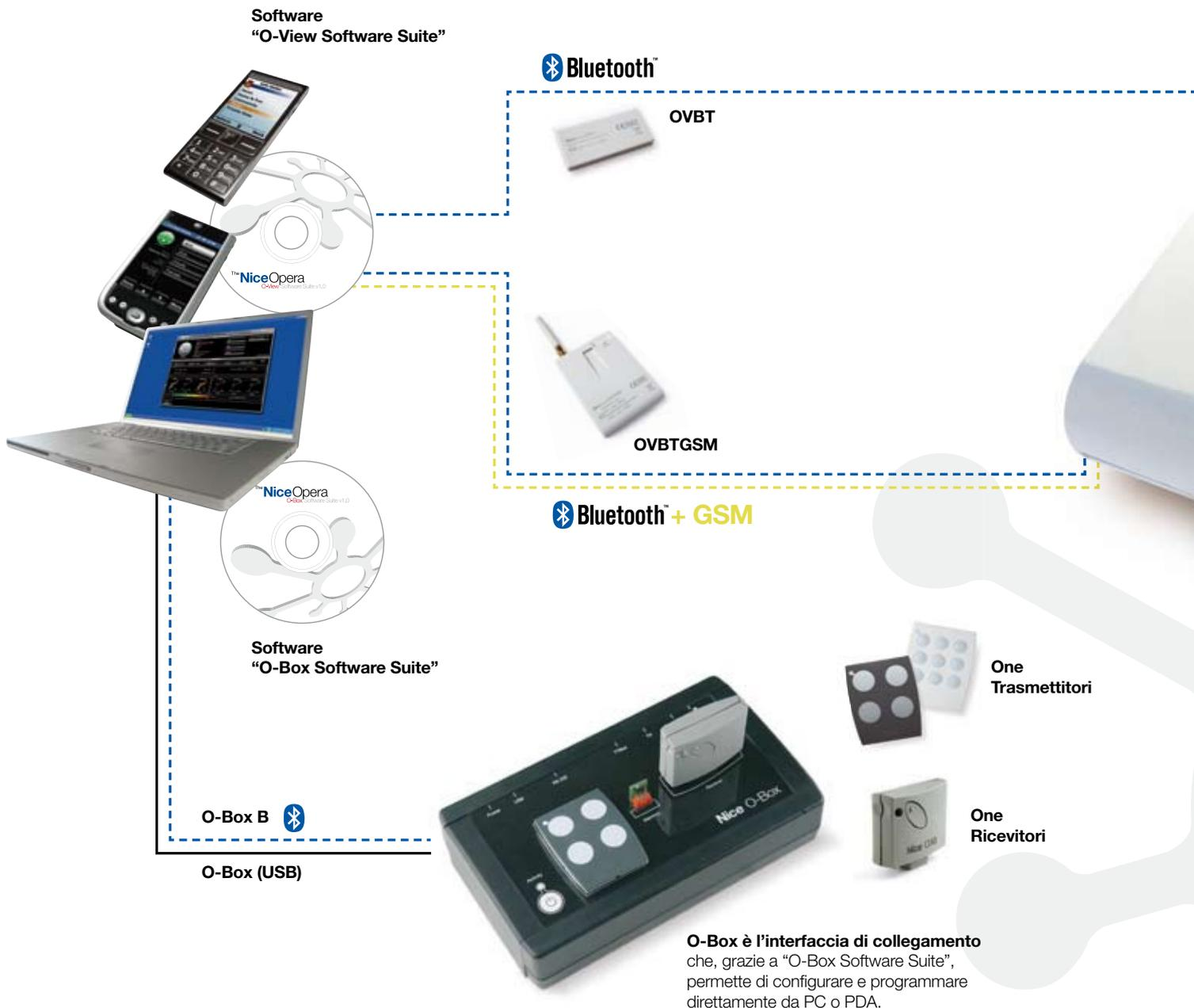
**Nice Opera** agevola l'installatore semplificando la programmazione, permettendo di accedere a tutti i parametri della centrale per adattare l'impianto ad ogni esigenza. Nessuna procedura specifica per ogni prodotto: unica modalità di programmazione con menù intuitivi, senza consultare istruzioni.
