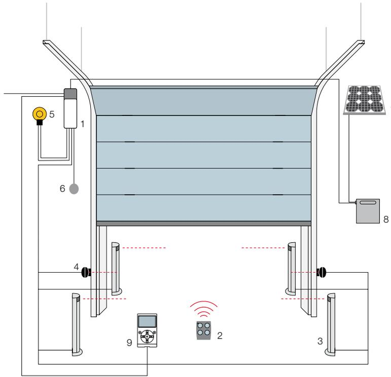
**1.** Soon **2.** Trasmettitore **3.** Fotocellule a colonna **4.** Fotocellule **5.** Luce lampeggiante **6.** Selettore a chiave o digitale
