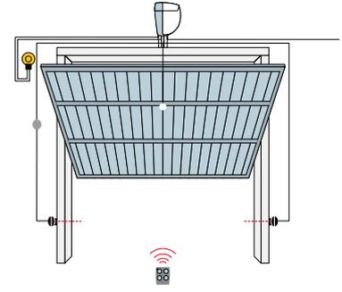
1. Spin 2. Trasmettitore 3. Fotocellule 4. Luce lampeggiante 5. Selettore a chiave o digitale.
