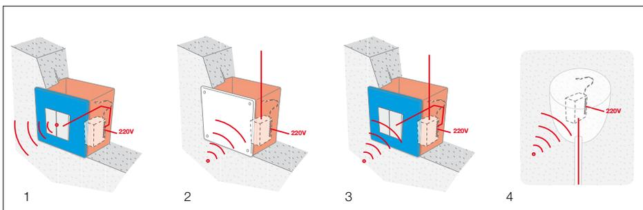
**1. TTX4:** trasmettitore da incasso con alimentazione da rete. Ideale per il comando di automazioni non raggiungibili direttamente via cavo.
