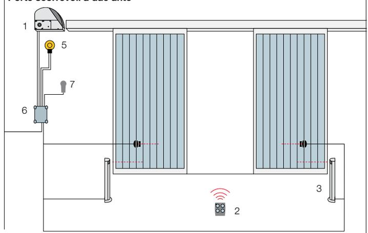
1. Sumo 2. Trasmettitore 3. Fotocellule a colonna 4. Fotocellule 5. Luce lampeggiante 6. Centrale di comando 7. Selettore a chiave o digitale.
