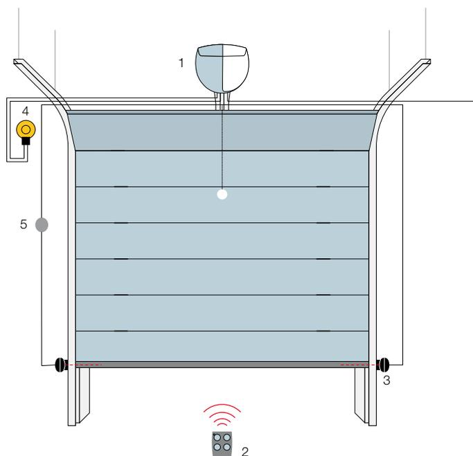
1. Spinbus 2. Trasmettitore 3. Fotocellule 4. Luce lampeggiante 5. Selettore a chiave o digitale.
