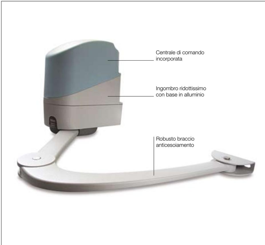
**Per cancelli a battente con ante fino a 2 m, anche con grandi colonne e strutture leggere, ideale per cancelli ad anta singola.** Motoriduttore elettromeccanico irreversibile 24 Vdc a braccio snodato, montaggio esterno. Uso intensivo.
