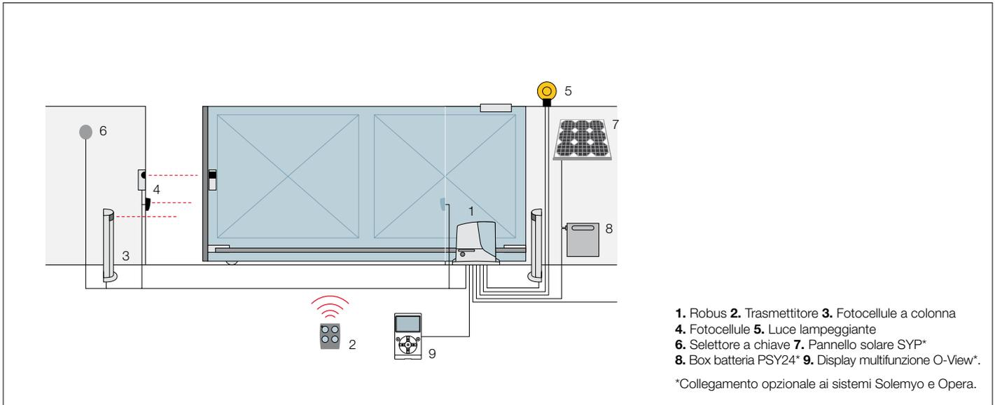
1. Robus 2. Trasmettitore 3. Fotocellule a colonna
