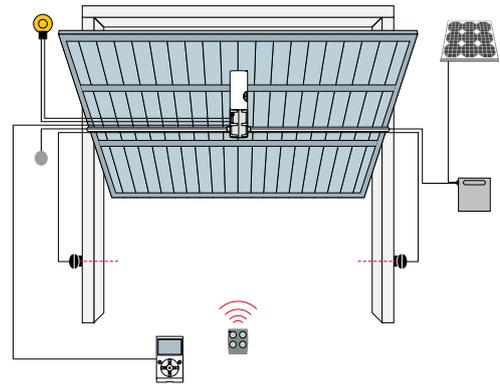
1. Ten 2. Trasmettitore 3. Fococellule 4. Luce lampeggiante 5. Selettore a chiave o digitale 6. Pannello solare SYP\* 7. Box batteria PSY24\* 8. Display multifunzione O-View\*.
