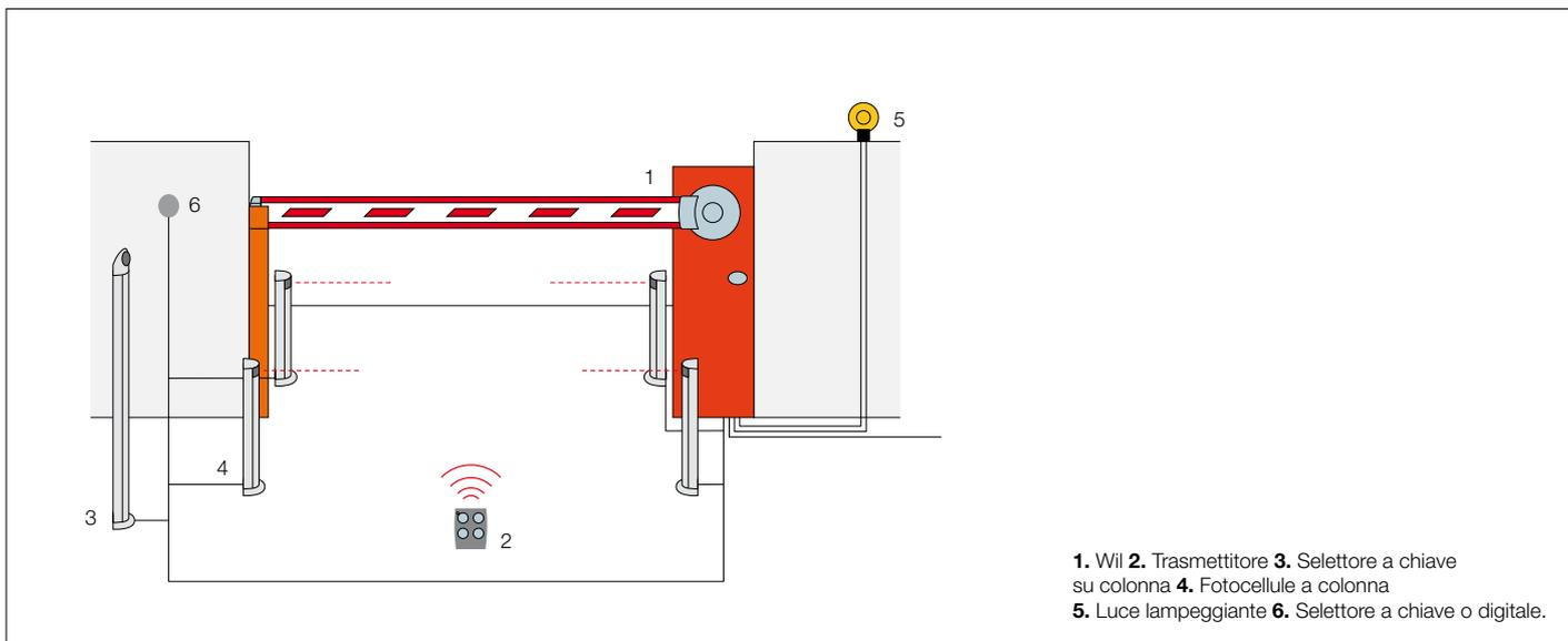
**1.** Wil **2.** Trasmettitore **3.** Selettore a chiave su colonna **4.** Fotocellule a colonna **5.** Luce lampeggiante **6.** Selettore a chiave o digitale.
