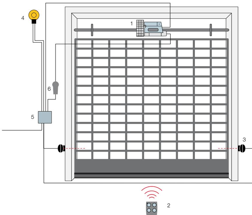
1. Rondo 2. Trasmittitore 3. Fotocellule 4. Luce lampeggiante 5. Centrale di comando 6. Selettore a chiave o digitale.
