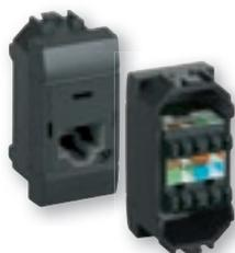
Sistema di connettori RJ45 in categoria 6 per postazioni di lavoro o pannelli di permutazione con connessione ad incisione d'isolante **mediante l'ausilio di attrezzi**, conformi alla normativa EN 50173-1 e EIA/TIA 568 A/B - 250 MHz, 1 Gbit/s. I connettori STP sono da utilizzarsi con cavo schermato F/UTP 22÷24 AWG a 4 coppie 100Ω e i connettori UTP sono da utilizzarsi con cavo non schermato U/UTP 22÷24 AWG a 4 coppie 100Ω.
