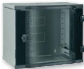
Quadro da parete 19" con porta frontale in vetro temperato bombato e con serigrafie ai lati, completi di aperture superiori ed inferiori per passaggio cavi, grigliature per areazione sulla testata e al fondo e serratura di sicurezza. Disponibili nella finitura di colore grigio chiaro RAL7035 con grado di protezione IP20 – IK 08.
