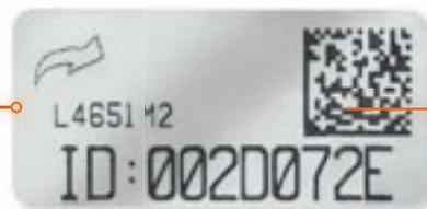
Codice ID di identificazione del dispositivo e codice DOT MATRIX per la lettura con lettore ottico
