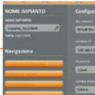
consente anche di realizzare la taratura definitiva dei sensori. Il medesimo file di progetto viene utilizzato per la programmazione della/e unità di controllo, tramite il software TiBMNE500. Livelli di illuminamento, tempi di ritardo, scheduling giornalieri, settimanali, annuali, profili orari, scenari: le funzionalità evolute del Lighting Management sono realizzabili da un unico supporto software. Come sempre lo sviluppo avviene comodamente in ufficio: in cantiere si realizza solo il download.
