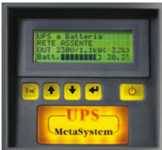
Il funzionamento a batteria è segnalato da un allarme acustico a intermittenza lenta, che può essere silenziato, e dal vistoso lampeggio giallo di tutto il pannello frontale.
