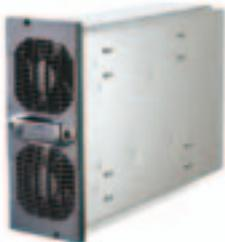
comando e controllo gestita da microprocessore. All'interno del rack, possono essere installati da 1 a 18 moduli potenza, parallelati tra di loro fino a raggiungere la potenza complessiva dell'UPS. Sono indipendenti l'uno dall'altro e garantiscono l'erogazione della potenza (residua) dell'Ups anche in caso di avaria di uno di essi. Grazie alla funzione Hot Swap, il ripristino avviene senza togliere alimentazione al carico o commutare il sistema in bypass.
