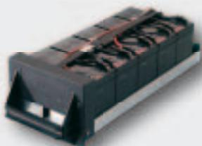
Il cassetto batterie TRIMOD consente l'aumento di autonomia, che potrà essere effettuato nel cabinet inverter, qualora vi sia posto per introdurre nuovi cassette batterie, o in cabinet batterie aggiuntivi. L'introduzione di cassette batterie (in multipli di quattro) e la possibilità di scegliere tra singole batterie da 7,2 a 9 Ah, offre l'opportunità di ottenere diverse configurazioni di autonomia ed agevola sia la messa in funzione dell'UPS sia l'eventuale intervento di manutenzione.
