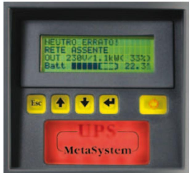
La lista degli eventi, accessibile dal pannello frontale, può contenere fino a 192 eventi successivi con data e ora di quando si sono verificati. L'autodiagnostica e la memorizzazione degli eventi rendono semplice l'identificazione di guasti hardware o anomalie nel funzionamento dell'UPS (sovraccarico, sovratemperatura, ecc.) e quindi velocizzano la risoluzione di eventuali problemi. L'orologio interno è regolato di default e prevede anche la gestione automatica dell'ora legale.
