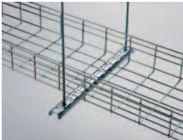
Il profilo ad aggancio rapido completa la gamma dello staffaggio della passerella a filo. Grazie al sistema di tasche e di asole sul fondo permette un'installazione rapida ed efficace sia nelle discese a parete sia nelle installazioni con barra filettata. La gamma è completa e dimensionata secondo le varie basi della passerella ed è disponibile nella finitura sendzimir e inox
