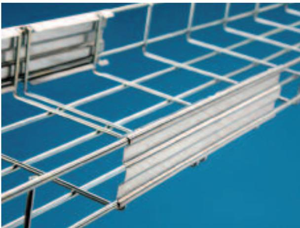
Il giunto lineare a scatto GFS ha una nervatura profonda e della stessa lunghezza del giunto: il risultato è una maggiore robustezza ed una maggiore capacità di carico di tutta la struttura.
